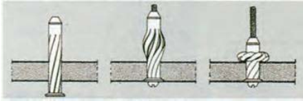
Molly anker za jednu ili dve ploče spušenog plafona
