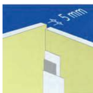
Spoj dve sečene Rigips ploče Ostavi fugu 5 mm i ogletovati samo jednu stranu sa bandaž trakom.
