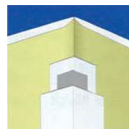
Spoj dve Rigips ploče sa Pro ivicama Krući spoj se izvodi samo sa papirnom trakom kod spoja dve gipskartonske ploče.
