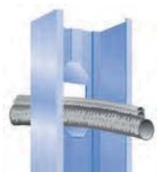
Provođenje instalacija kroz proreze CW profila.
