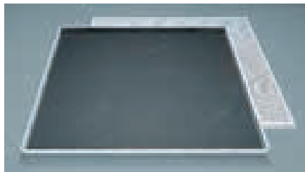
Ploča sa crnim akustičkim filcom, 63 g/m 2
