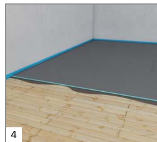
4 Građevinsku ploču položiti u lepak na smicanje u odnosu na spojeve (izbeći krstaste spojeve).
