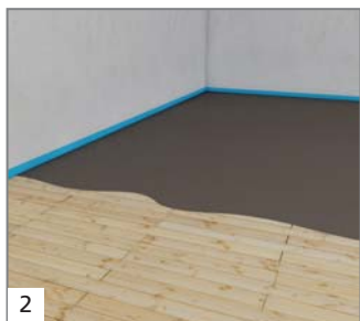
2 Nanošenje lepka za keramičke pločice na drvenu podlogu.
